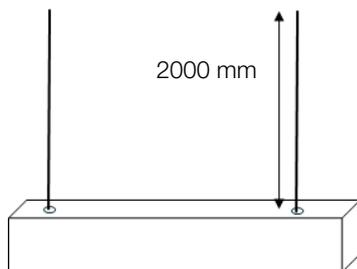
**Instalación:** Coloque los accesorios de anclaje al plafón tomando en cuenta la distancia de la luminaria, ancle el otro extremo del cable de acero a la luminaria.
