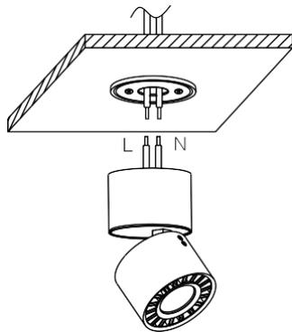
CONECTE LA LUZ A LA TERMINAL DE SALIDA DEL LUMINARIO
