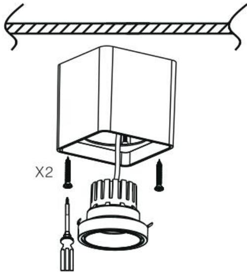
UTILICE EL TORNILLO PARA FIJAR EL MÓDULO DE LUZ EN EL TECHO DONDE ESTÁ LA POSICIÓN DE INSTALACIÓN
