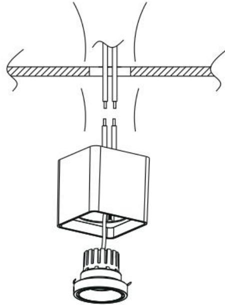
PERFORAR UN AGUJERO EN EL TECHO, LUEGO CONECTE EL CONDUCTOR A LA ALIMENTACIÓN PRINCIPAL
