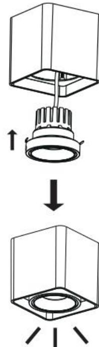
FIJA LA PARTE DEL MÓDULO DE LUZ EN LA BASE, LUEGO PRUEBE EL ELÉCTRICO
