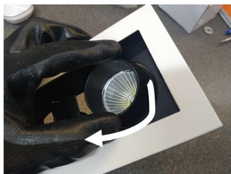
4. Colocar la tapa, girando hacia la derecha
