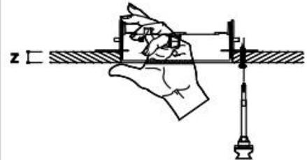
fije dos soportes del kit de montaje con 4 tornillos
