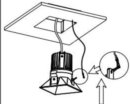
Inserte el controlador LED, bloquee el cable anti-tirón y todo el cable sobrante en el techo, luego inserte con cuidado el accesorio en el kit de montaje hasta que el accesorio quede bloqueado por resortes dentro del marco.
