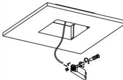
Conecte los cables de alimentación de la fuente de alimentación de CA al lado primario (L&N) del controlador.
