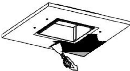
Recubre el techo de yeso para ocultar tornillos y kit de montaje
