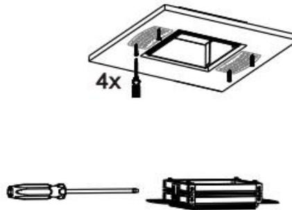
Según el grosor del techo, ajuste el marco y apriete los tornillos.
