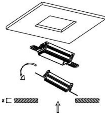
coloque el kit de montaje en el orificio del techo
