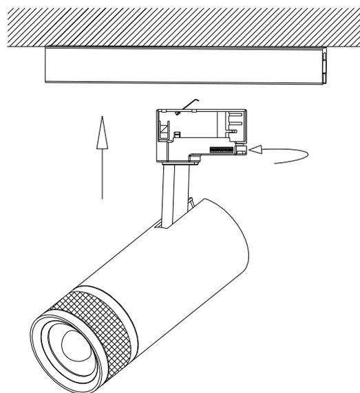
Junta al riel los 4 clips de lámpara en la ranura, fija el cuerpo de la lámpara usando la palanca de anclaje.
