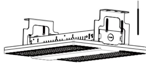
Conecte los cables que alimentan al driver respetando los colores y especificaciones que indica el luminario. Aisle los cables correctamente y proceda a introducirlos en el orificio del cable de alimentación
