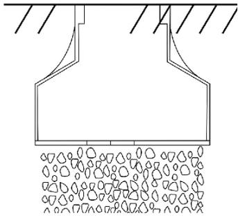
Coloque el housing de plástico sobre el muro o piso del área a instalar y abra un hueco que le permita introducir este en el espacio. Considere que es necesario poner debajo del luminario para el caso de uso en piso una cama de 30 cm. de grava en la parte profunda del hueco, para usarse como dren del agua (NO HACER ESTO PODRÍA RESULTAR EN EL DAÑO DEL LUMINARIO POR INUNDAMIENTO Y PERDIDA DE LA GARANTÍA).
