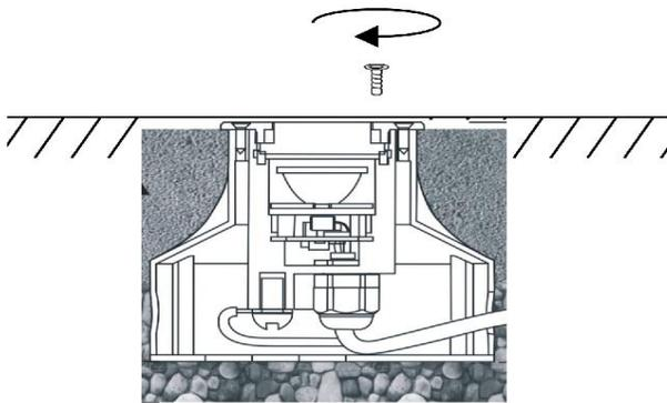
Inserte el luminario en el housing apretando los tornillos.
