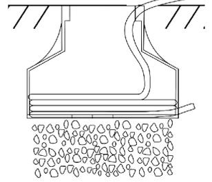
Conecte el luminario siguiendo el método de aislamiento con cinta vulcanizada, Deje el exceso del cable dentro del housing para facilitar futuros mantenimientos.
