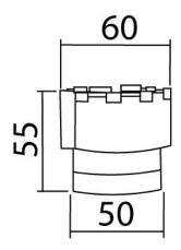
**Instalación:** Crear perforación dependiendo del arillo que se le coloque y cablear el luminario, subir los resortes e introducir el luminario.
