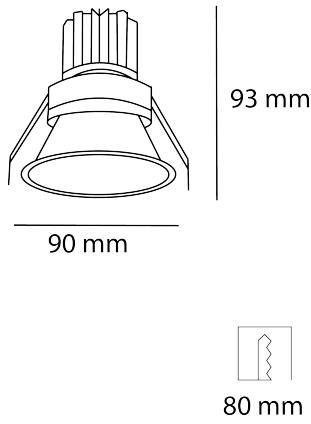
**Instalación:** Crear perforación de 80 mm y cablear el luminario. Subir los resortes y depositarlo dentro.
