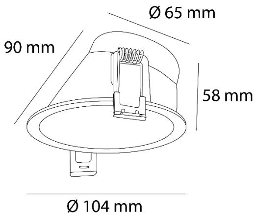
**Instalación:** Crear perforación circular de 93 mm y cablear el luminario, subir los resortes e introducir el marco.
