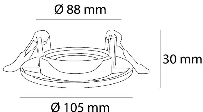
**Instalación:** Crear perforación circular de 88mm y cablear el luminario subir los resortes e introducir el marco
