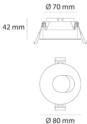
**Instalación:** Crear perforación circular de 70 mm y cablear el luminario, subir los resortes e introducir el luminario.
