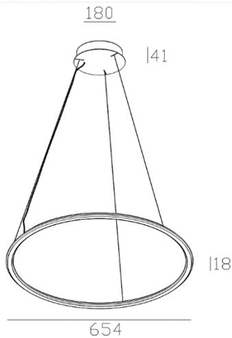
instalación: Colocar el canope sobrepuesto en el plafón o techo, sujetándolo con los taquetes y tornillos que trae dentro de la caja, cablear el luminario y sujetarlo en el canope
