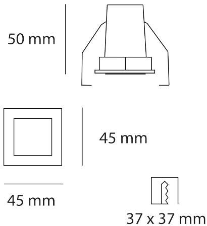
**Instalación:** Realizar un agujero cuadrado de 37 X 37 mm, cablear, colocar los resortes hacia arriba, e introducir el luminario.
