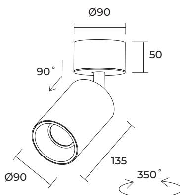
**Instalación:** Fijar la base a techo, cablear y colocar el luminario a presión en la base.
