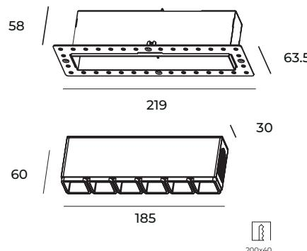
**Instalación:** Realizar un agujero cuadrado de 200 X 40 mm, cablear, colocar el luminario fijar las pestañas y cubrirlas .
