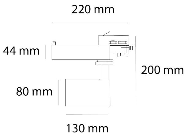
**Instalación:** Deslizar el luminario sobre el riel y poner el seguro.
