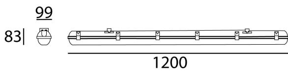
**Instalación:** Para el montaje se fijan los soportes al techo y se coloca a presión el luminario.
