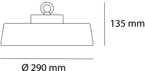
**Instalación:** Para montaje en suspensión, cuenta con una argolla para sujetar y salida con cable de uso rudo.
