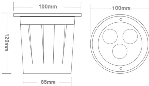
**Instalación:** Crear perforación en piso de 12 cm de profundidad y 8.5 cm de ancho, introducir la caja de empotrar, cablear y atornillar el luminario.
